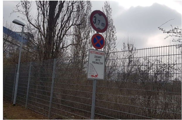
Abb. 23 Kennzeichnung einer Feuerwehrezufahrt auf Privatgelände [c]
